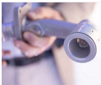
Figura 6 - Bicos de combustível do motor Leap 1 feito através da MA
