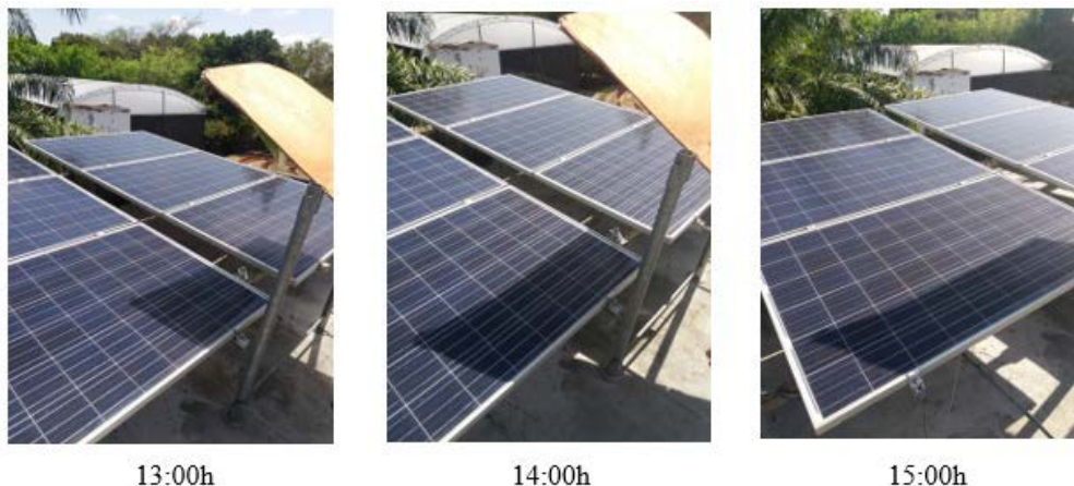
Figura 18 – Experimento de sombreamento dinâmico realizado no dia 26/09/2018
