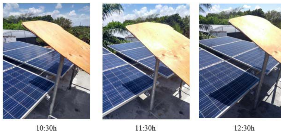
Figura 22 – Experimento de sombreamento dinâmico realizado no dia 27/09/2018
