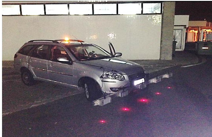
Figura 1 – Veículo e equipamento com perfilômetro inercial a laser.
