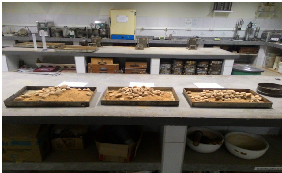
Figura 3.4: Misturas solo-seixo utilizadas nos ensaios de compactação e CBR
