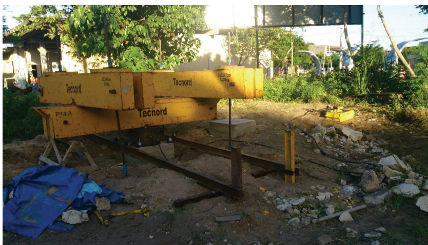
Figura 4 – Sistema de reação montado no campo experimental da Unifor.
