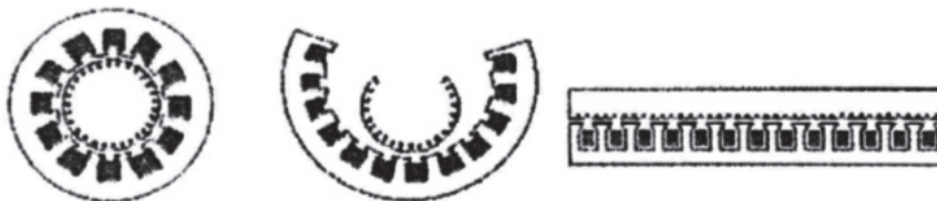
Figura 1: Obtenção de um motor linear a partir de um rotativo.
