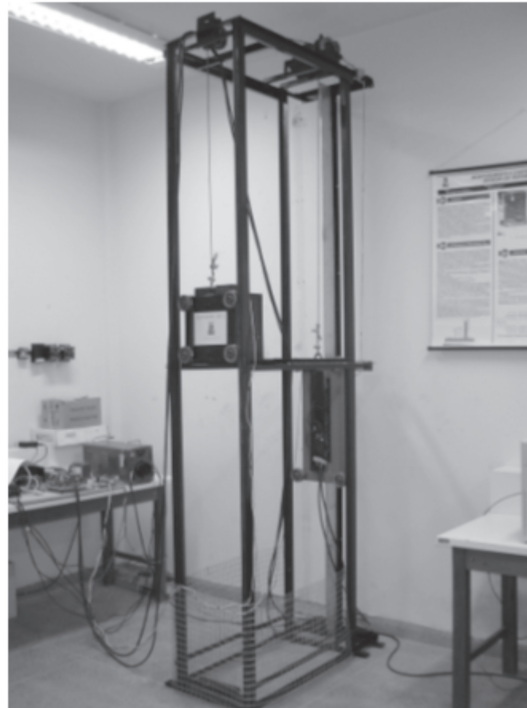
Figura 9: Estrutura do elevador finalizada.
