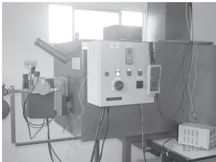
**Figura 5:** Montagem experimental e instrumentação da câmara de combustão
