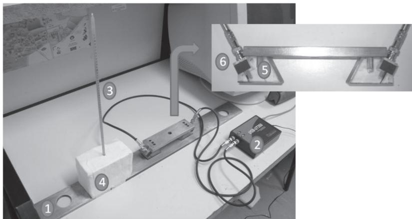
**Figura 5:** Arranjo experimental para medir o tempo de percurso e a temperatura da chapa.
