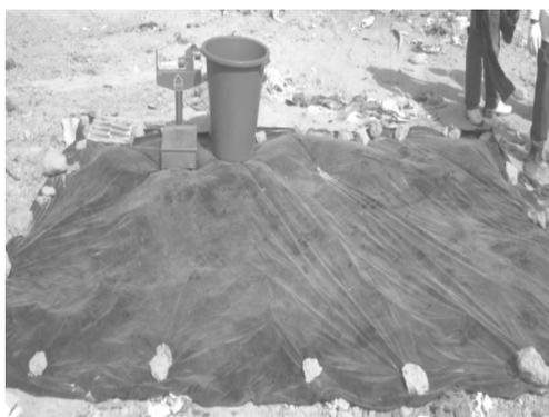
Figura 1: Vista da lona, da balança e do tambor utilizados
