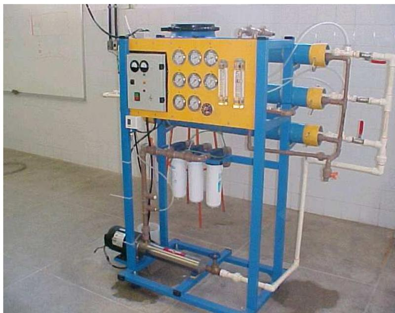
**Figura 3:** Dessalinizador instalado no Laboratório de Hidráulica do Depto. de Eng. Hidráulica e Ambiental (UFC). Destacam-se os seguintes componentes: 3 vasos de membranas; painel de controle com a parte elétrica (no lado esquerdo); medidores de pressão (no centro) e dois rotâmetros para medição de vazão.
