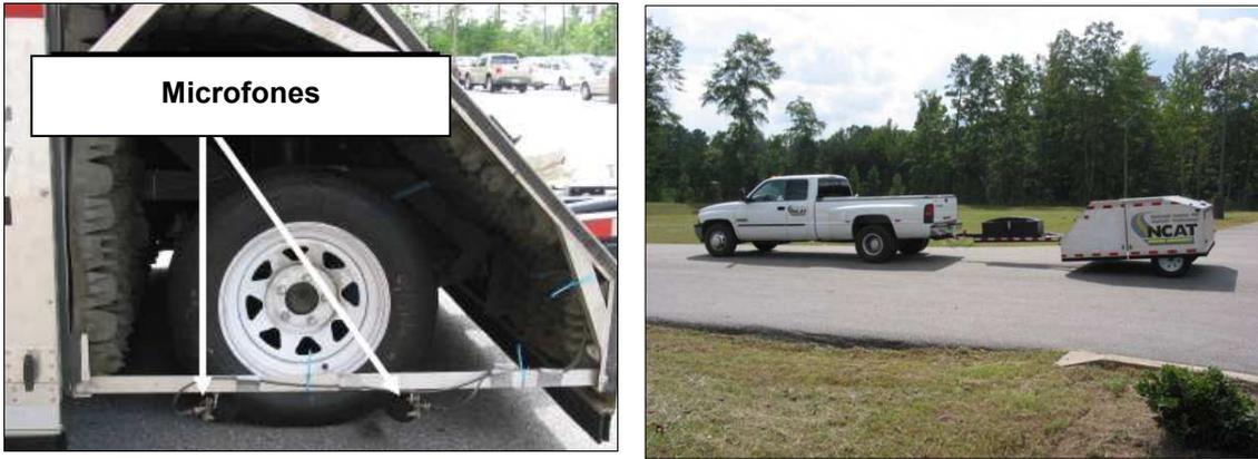
**Figura 3:** Equipamento de ensaio do método CPX
