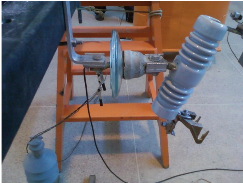
Figura 15: Ensaio com chave fusível com duplo isolamento.
