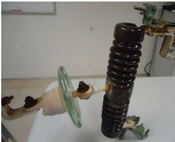
Figura 10: Segundo protótipo da chave fusível com duplo isolamento.
