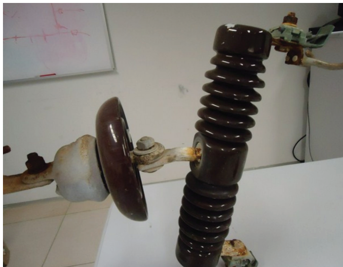
Figura 9: Primeiro protótipo da chave fusível com duplo isolamento.
