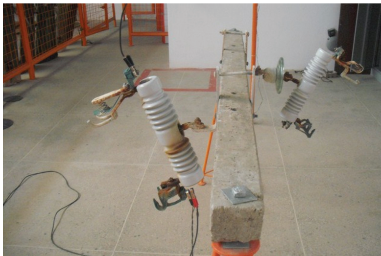
Figura 16: Chaves fusíveis utilizadas nos ensaios.
