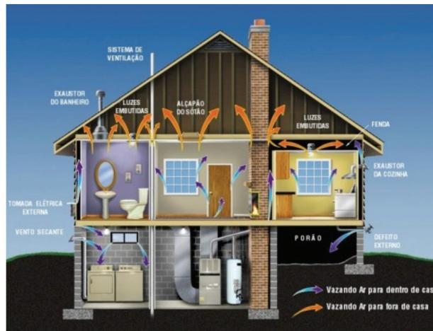
**Figura 5:** Esquema de possíveis formas de infiltração em uma residência.
