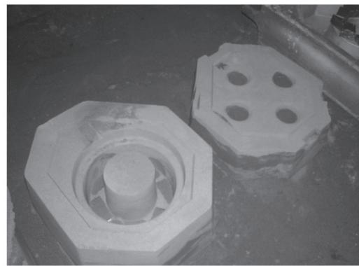
**Figura 7:** Partes inferior e superior do molde.
