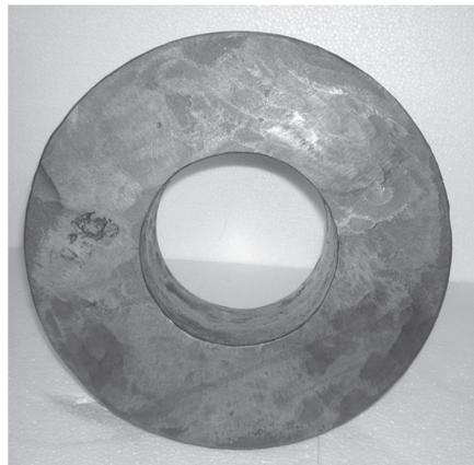
**Figura 9:** Peça em bruto com descontinuidade visível na região do alimentador.
