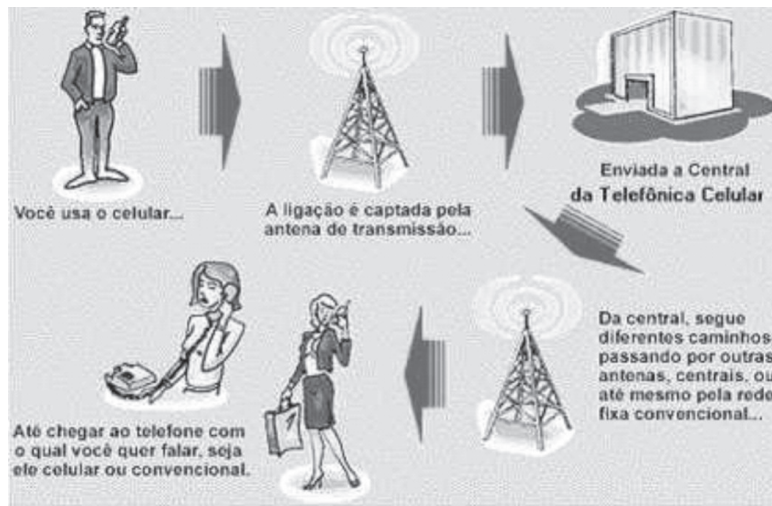
Figura 2: Esquema ilustrativo da telefonia celular
