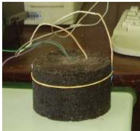
Figura 1: Amostras de concreto asfáltico
