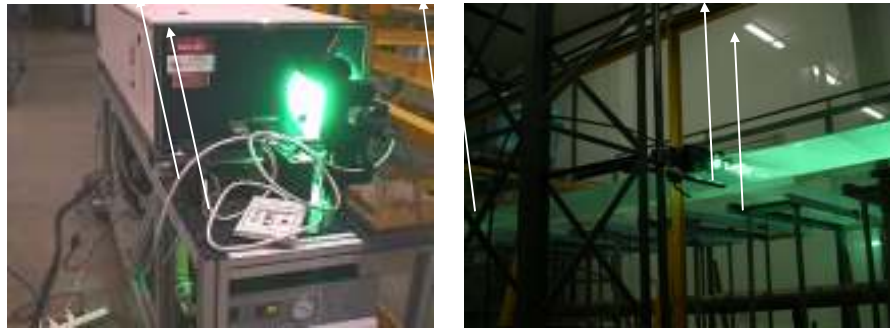
Figura 3: Luz gerada pelo equipamento laser. Conjunto de lentes posicionado ao lado do reservatório, inserindo o plano de luz no escoamento através de uma parede lateral.
