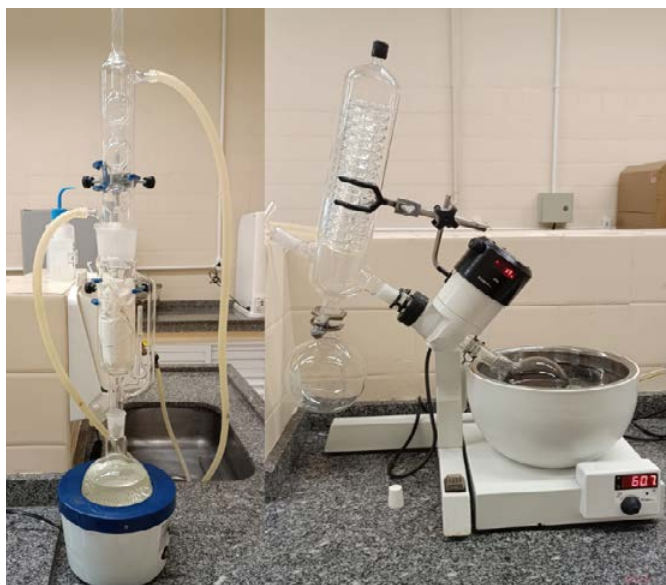
Figura 4 – Extração por solvente com aparelho de Soxhlet
