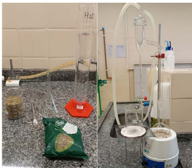
Figura 3 – Extração por hidrodestilação com aparelho de Clevenger
