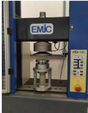
Os corpos de prova foram rompidos com a idade de 7, 14 e 28 dias, e foram ensaiados 5 corpos de prova em cada idade. No dia anterior ao rompimento, estes corpos de prova foram secados em estufa.
