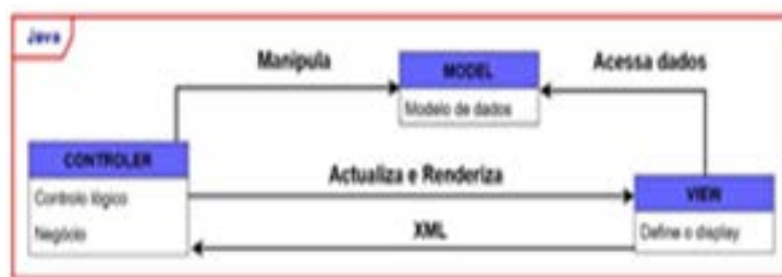
Figura 3. Arquitetura Model-View-Controller, utilizado pelo Framework IGRP-Web.
