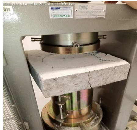
(a) Posicionamento para teste de compressão (b) Deformação após teste de compressão
