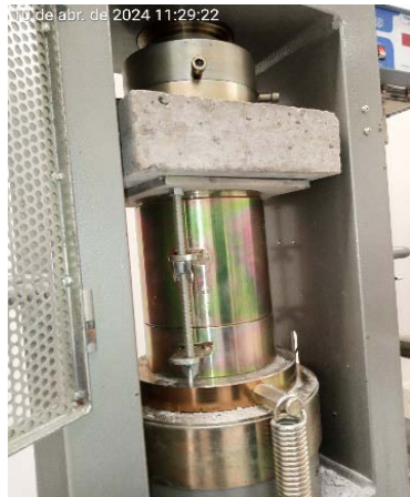
(a) Posicionamento para teste de compressão (b) Deformação após teste de compressão
