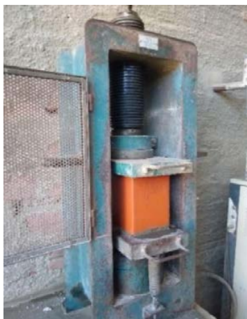
Figura 5: Ensaio de compressão de bloco estrutural cerâmico
