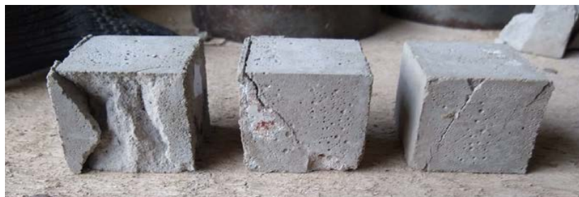
Figura 7: Corpos de prova de argamassa cúbicos após o rompimento
