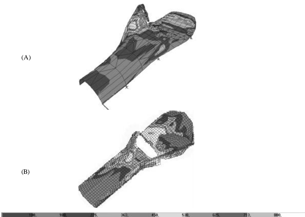
Figura 3.1. Resultado da simulação das órteses no programa SAP 2000. (A) Modelo de posicionamento ventral. (B) Modelo de posicionamento dorso-ventral, à direita pode ser observada a malha do modelo. Valores de tensão em Pa.
