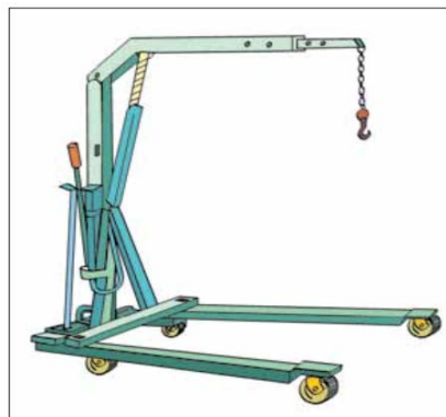
Figura 5 – Sugestão de dispositivo mecânico para levantar peças até a altura de trabalho
