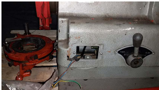
Figura 6 – Rosqueadeira sem botoeira de acionamento
