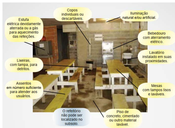
Figura 30 – Exemplo de refeitório atendendo as exigências da NR-18
