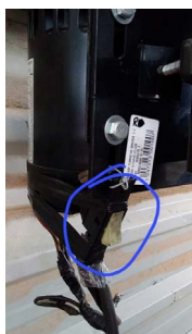
Figura 8 – Interruptor improvisado para acionar a furadeira 01
