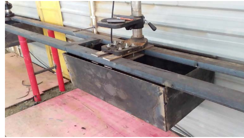
Figura 11 – Caixa para coleta de resíduos da furação
