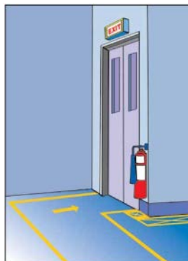
Figura 23 – Sinalização de rota de fuga
