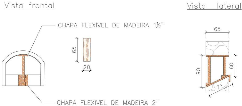
Figura 14 – Escoramento dos óculos.
