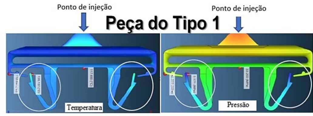
Figura 10 – Análise da Simulação computacional no momento de preenchimento da matriz com plástico para a peça do Tipo 1. As regiões destacadas com círculos (cor branca) mostram a parte mais crítica na fabricação.
