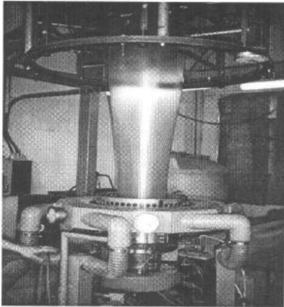
Foto 24 – Filme plástico sendo resfriado, colado, picotado e enrolado na forma de saco plástico.
