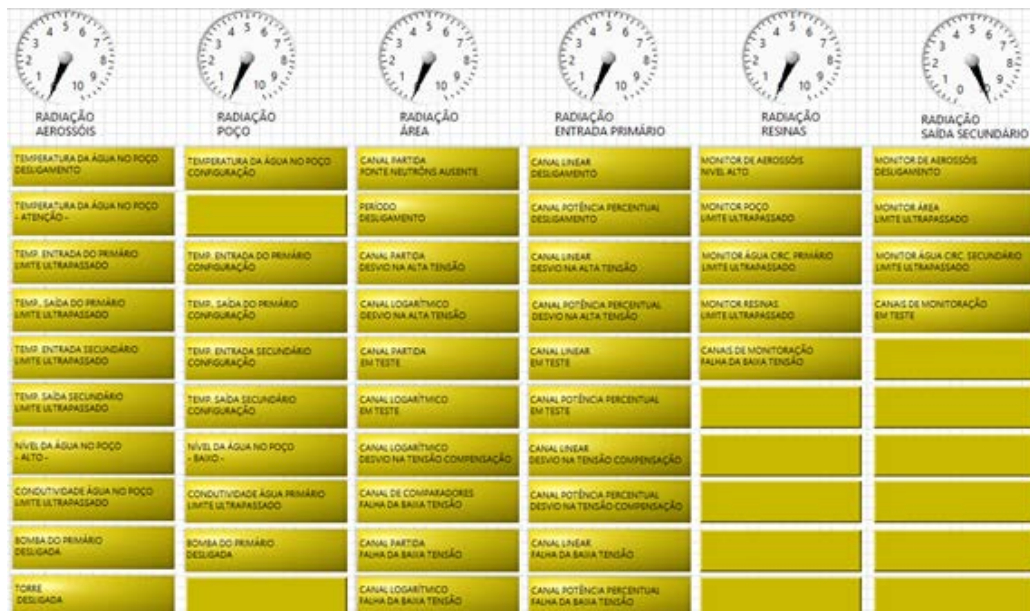
Figura 9 – Interface visual para a parte direita da mesa de controle: monitoramento de radiação e alarme
