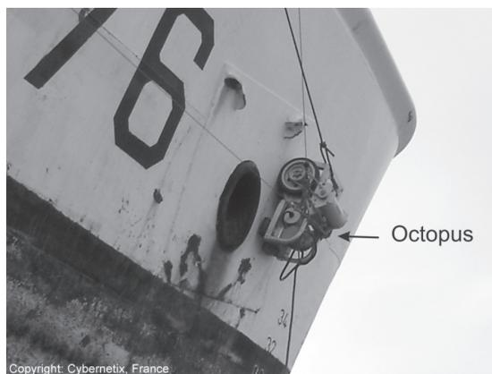
**Figura 12:** Octopus inspecionando casco de um navio.
