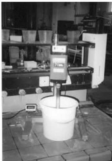
Figura 9: Misturador ULTRA-TURRAX T50 com medidor de rotação e equipamento de dispersão (AGUIAR, 1997).
