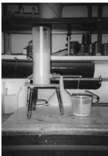
Figura 13: Vista do ensaio “Kasumeter” (AGUIAR, 1997).
